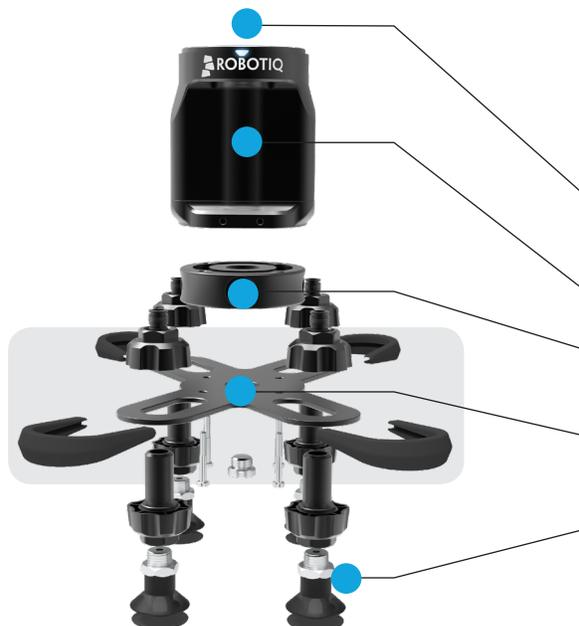
Er kann direkt an der Robotiq Handgelenkkamera und der Standardkupplung für Robotiq Produkte montiert werden
