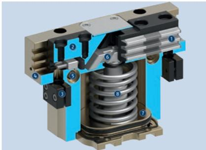
Die mechanische Greifkrafterhaltung stellt auch bei Druckabfall eine Mindestgreifkraft sicher. Diese wirkt bei der AS-Variante als Schließkraft und bei der IS-Variante als Öffnungskraft. Das Bild zeigt die AS-Variante. Die Greifkrafterhaltung lässt sich auch als Greifkrafterhöhung oder für einfach wirkendes Greifen nutzen.
